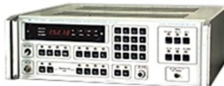
В измерителе модуляции СКЗ-45 предусмотрена возможность работы со сменными блоками Я4С-103 и Я4С-103А, предназначенными для расширения диапазона частот входного сигнала.
