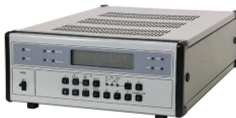
Компаратор измеряет временной сдвиг импульсов внешней или вспомогательной шкалы времени (ШВ) относительно основной ШВ; формирует: сигналы частотой 1 и 10 МГц из опорного сигнала 5 МГц; сигналы основной и вспомогательной (задержанной) ШВ с периодом следования импульсов 1 с; отображает на табло текущее время в часах, минутах, секундах.
