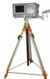
Обеспечивает проведение отдельных измерений горизонтальной и вертикальной составляющих электромагнитного поля. Антенна соответствует требованиям ГОСТ РВ 50858-9
