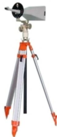
Антенна обеспечивает проведение отдельных измерений горизонтальной и вертикальной составляющих электромагнитного поля.
