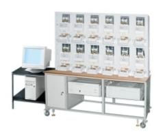
УАПС-2 представляет собой образцовый ваттметрсчетчик класса 0,2 и источник фиктивной мощности, конструктивно выполненные в одном блоке. При объединении нескольких блоков возможно одновременное подключение до 36 электросчетчиков.
