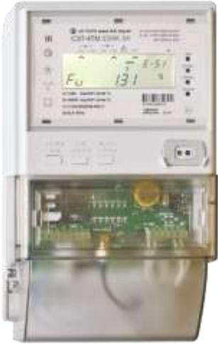
Счетчик предназначен для многотарифного учета активной и реактивной энергии в двух направлениях (в том числе и с учетом потерь), ведения массивов профиля мощности нагрузки с программируемым временем интегрирования (в том числе и с учетом потерь), фиксации максимумов мощности, измерения параметров трехфазной сети и параметров качества электрической энергии для непрерывного мониторинга.
