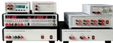
Расширение диапазона напряжений обеспечивают высоковольтный (Н4-12БВ) и низковольтный (Н4-12БН) блоки, а расширение диапазона воспроизводимых токов – преобразователь напряжение-ток Я9-44.
