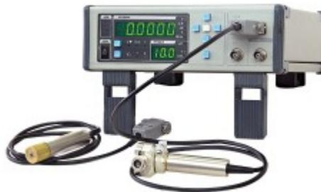
Вход № 3 измерительного канала № 3 выполнен в виде выносного амплитудного преобразователя, построенного на диодах Шоттки и заключенного в выносной высокочастотный пробник П2, подключаемый к измерительному блоку вольтметра, и предназначен для измерения повышенного уровня непрерывных сигналов напряжения и мощности низкой и высокой частоты.
