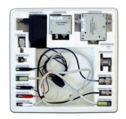
вольтметром постоянного напряжения при поверке высокочастотных вольтметров видов ВЗ, В4, В7, генераторов – ГЗ, Г4 и аттенюаторов – Д2. Преобразователь В9-26 допускает индивидуальную аттестацию в диапазоне частот до 1000 МГц в качестве вольтметра-эталона 2-го разряда. Индивидуально аттестованный преобразователь имеет в 1,5–2 раза сниженную частотную погрешность.
