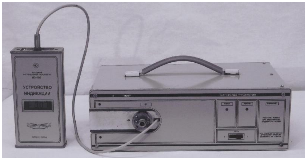
Рисунок 2 - Общий вид ваттметра М3-105
